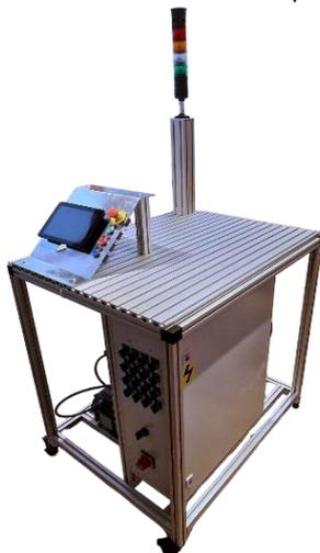
Le banc d'essai peut être équipé d'une maquette qui peut être connectée via un connecteur Harting. J'ai donc connecté les entrées et sorties des automates pour pouvoir programmer la future maquette.
