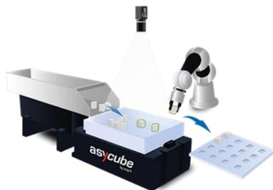
La localisation et le tri des pièces sont réalisés à partir du système EYE+ de Asyrcil, composé d'un Asycube 240 et le système de vision.
