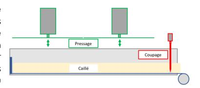
La partie automation de cette machine devenant obsolète, il est nécessaire de remettre l'installation au goût du jour afin de garantir une certaine fiabilité à long terme. Un automate \$7-1200 va être installé.
